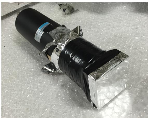
3. その上から遮光テープを巻きつける。このときシンチレーターと PMT が動かないよう固定されているか、シンチレーターに光が入らないように全体的に遮光されているかを確認する。
