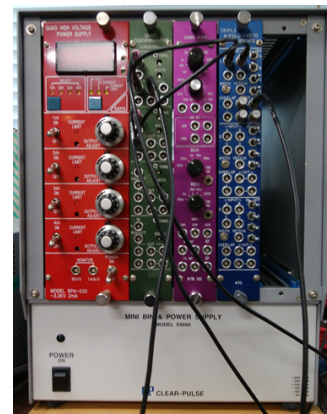
図 5.3 NIM モジュール。左から、高圧電源、discriminator、clock generator、coincidence である。
