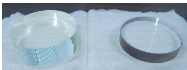
図 3.2 検出体。左はプラスチックシンチレーター（半径 25mm 厚さ 20mm）、右は石英ガラス（半径 25mm 厚さ 10mm 屈折率 1.5）である。
