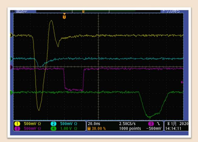
黄色:1個目のシンチレーションカウンターからの出力信号
