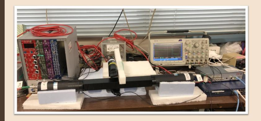
発泡スチロールで囲みこんで、長いシンチレーションカウンタの真ん中に短いシンチレーションカウンターを固定して測定した。
