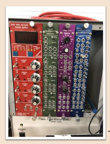
赤: High Voltage 高電圧を印加する電源モジュール
