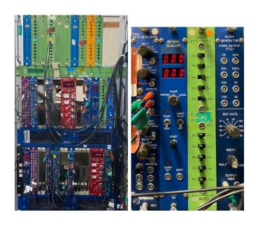
図 2.7 左図: 本実験で使用している NIM モジュール 右図: 主な NIM モジュール
