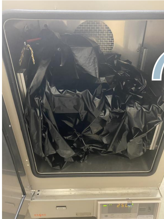
写真：恒温槽内部 装置に暗幕をかけた
