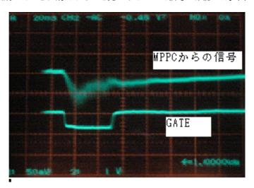
図 13 LED 点灯時の MPPC 波形
