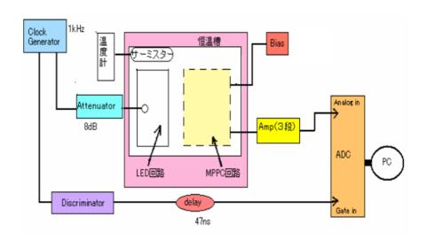
図 8 LED 点灯時の Block Diagram
