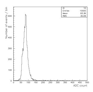
図 35 B:下のシンチレーターのみ threshold を掛けた場合:Sr 有
