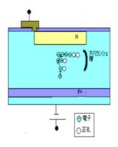
半導体中に大きな電界があると、光子の衝突によって発生する電子が加速され、ほかの半導体原子と衝突 して複数の電子をはじき出す。ここではじき出された電子は電界によって加速され、ほかの半導体電子に衝突 してさらに電子を弾き出す。この連鎖によって、移動する電子が指数関数的に増える現象をアバランシェ増倍と言う。これはフォトダイオードの受光感度を大きく上昇させることが可能である。つまりアバランシェ増倍と呼ばれる現象を利用して受光感度を上げたフォトダイオードだといえる。
