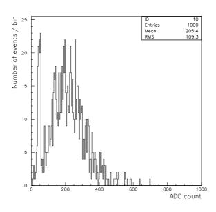
図 39 D:両方のシンチレーターに threshold を掛けた場合:Sr 有
