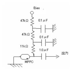
図 4 MPPC の基本接続回路
