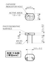
図3 MPPC の外寸図
