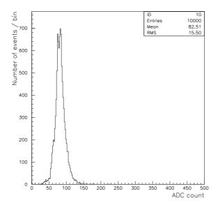
図 36 B:下のシンチレーターのみ threshold を掛けた場合:Sr 無
