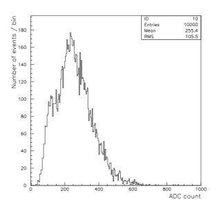
図 37 C:上のシンチレーターのみ threshold を掛けた場合:Sr 有
