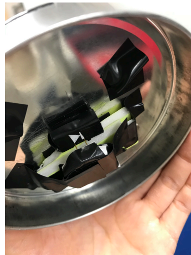
図 4.7 PD に限りなく近づけた ^{241}\text{Am} 線源
