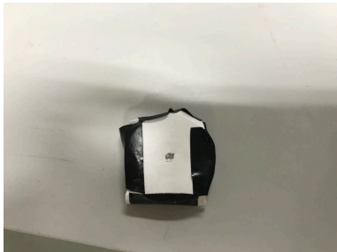
図 4.6 穴の開いた紙をつけた ^{241}\text{Am} 線源
