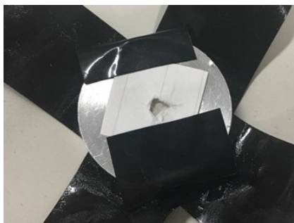
図 4.1 穴の開けた紙をつけた ^{241}\text{Am} 線源
